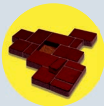
Расшатывание брусчатки и западание отдельных плит
